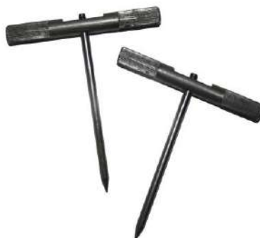
Рисунок 11 - Приспособления для крепления сейсмоприемников на грунт
