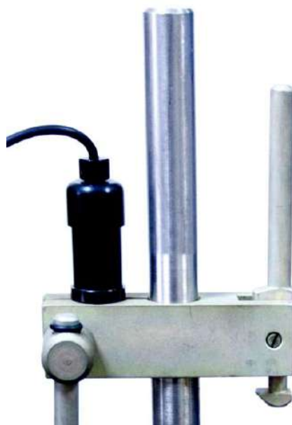
Рисунок ПБ.4 – Установка сейсмоприёмника на темпер
